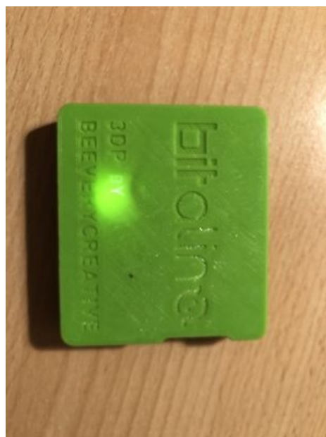
Signalizace zapnutého BITalina s problikávající diodou
