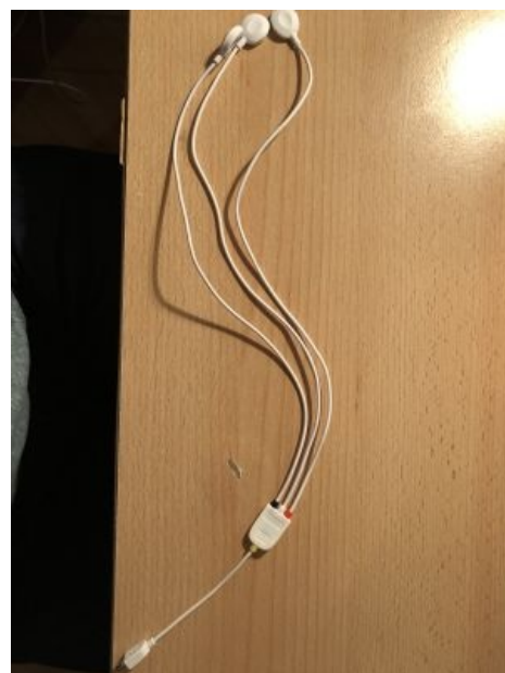
Trojcestný snímač (červená - pozitivní elektroda, černá - negativní elektroda, bílá - referenční elektroda)
