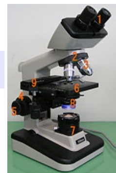
Hlavní součásti světelného mikroskopu: 1) okulár, 2) otočný revolver, 3) objektiv, 4) makšroub, 5) mikrošroub, 6) stolek, 7) světelný zdroj, 8) kondenzátor a clona, 9) křížový posun
