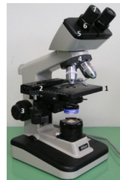
Mechanická soustava optického mikroskopu: 1) stolek, 2) křížový posun, 3) makrošroub a mikrošroub, 4) revolver, 5) tubus, 6) zaostřovací kroužek, 7) očnice.
