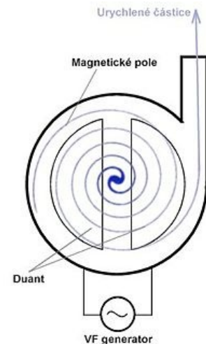
Schematické znázornění cyklotronu
