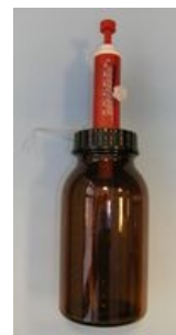
Pístoventilový dávkovač
