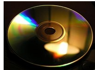
Rozklad světla na difrakční mřížce kompaktního disku
