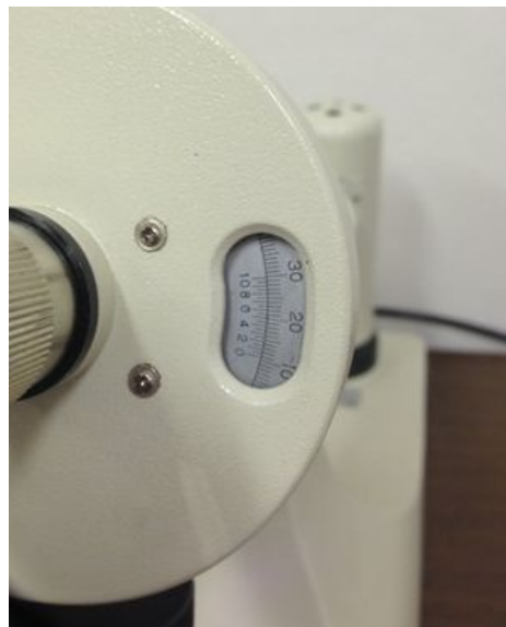
Noniová stupnice polarimetru
