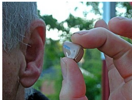
Nitroušní sluchadlo – ITE (in the ear)
