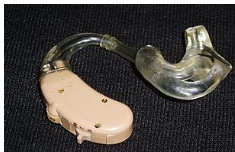
Závěsné sluchadlo – BTE (behind the ear)
