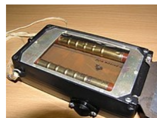
Ionizační komory v dozimetru
